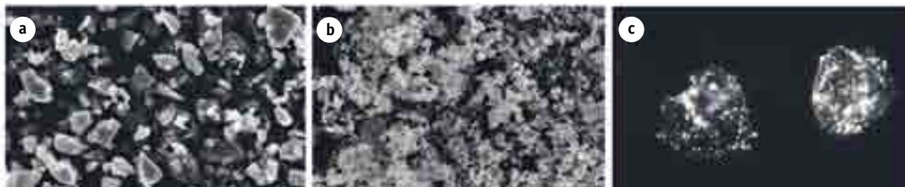
Figur 1. Bilder från Skanning Elektron Mikroskop (SEM) av mikropartiklar med stor variation i storlek (a) och nanopartiklar (b). (c) Foto taget med CytoViva-mikroskop som visar celler med partiklar i cellmembranen.
