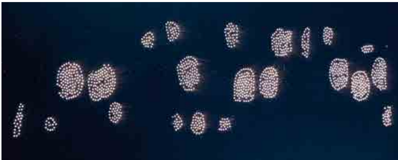
● 20 sekunder "Selective Laser Melting", SLM. Varje ljuspunkt motsvarar en kort lasersmältning av metallpulvret.
