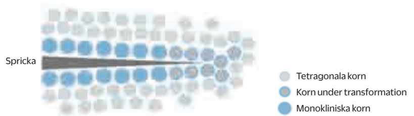
Figur 1. Lokala dragspänningar vid en defekts sprickspets leder till en t-m -transformation av zirkoniumoxidkornen i det spänningsutsatta området, vilket föranleder en expansion motsvarande 3–5 procent i det omgivande materialet. Detta resulterar i en lokal kompressions-spänning vid sprickspetsen, som i sin tur motverkar vidare spricktillväxt. Kornstorleken i materialet varierar från 0,2 till 0,8 µm. Figuren är modifierad från Piconi och Maccauro (1999).
