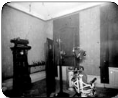
Tandläkarinstitutet i Stockholm fick sin första röntgenapparat 1912. De oisolerade elektriska ledningarna gick från generatormotorn vid väggen till glasröret ovanför tandläkarstolen. (Bild: Sven Lindskog)
