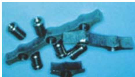
Figur 1. Den första generationen titanskelett (Ti-1) består av barkomponenter med cylindrar som fogas samman med lasersvetsning.
