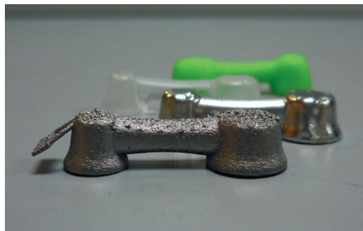
Figur 1 Fyra stilistiska broskelett som representerar fyra olika framställningstekniker för ett och samma material: Lasersintrat CoCr, fräst CoCr, förlaga för gjutning av CoCr framställd genom fräsning i urbrännbart material, vaxförlaga för gjutning av CoCr enligt lost wax-metoden. De tre första är framställda med CAD/CAM-teknologi.
