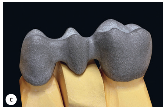
Figur 11 a–c Lasersintring: (a) Bilden visar lasern i arbete med att smälta pulverpartiklar i pulverbädden, (b) visar färdiga kronhåttor och broskelett när det osmälta pulvret är avlägsnat och (c) visar ett färdigt bro- skelett.
