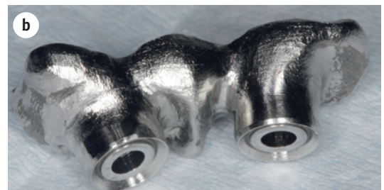
Skelett framställda med de olika teknikerna fräst (a) och sintrat (b).
