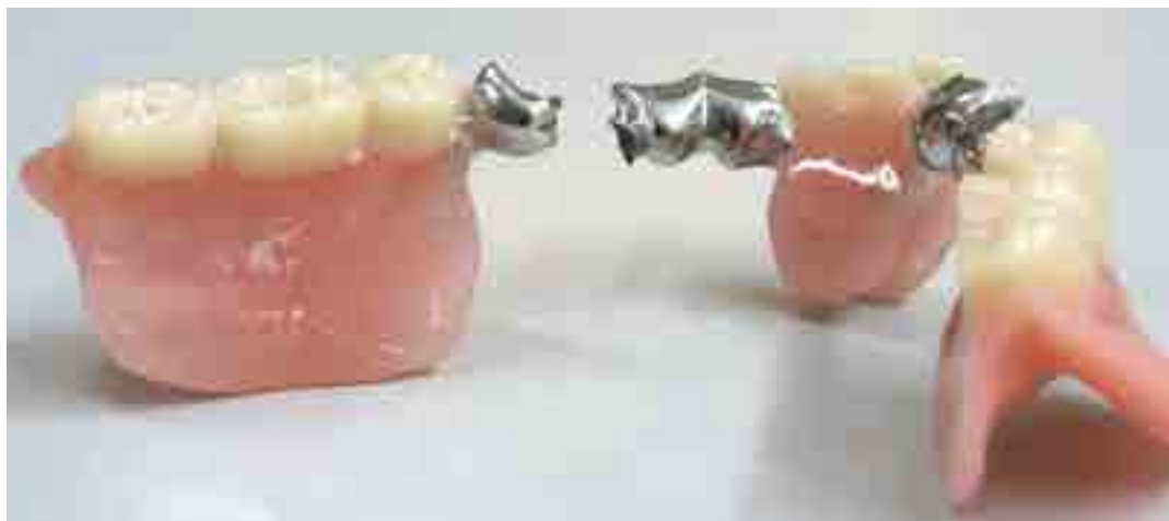
Figur III. Frakturerad delprotes med porositeter i frakturetan.
