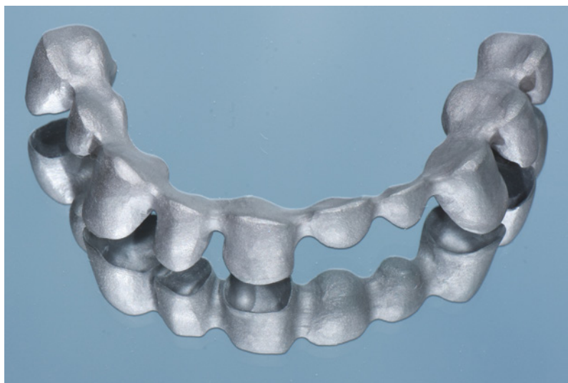
Figur I. Exempel på ett broskelett tillverkat genom selektiv lasersmältning (SLM) av kobolt-kromlegering.
